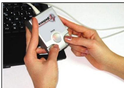
Рис. 1. Микропроцессорный сенсор ИТ ФАЗАГРАФ®
