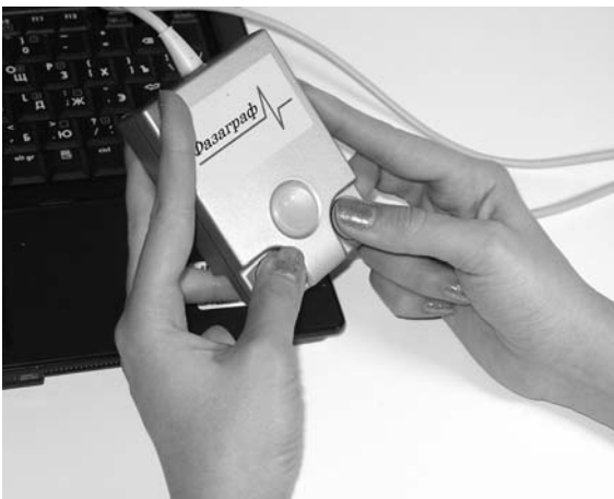
Рис. 6. Пристрій для реєстрації ЕКГ з пальцевими електродами
