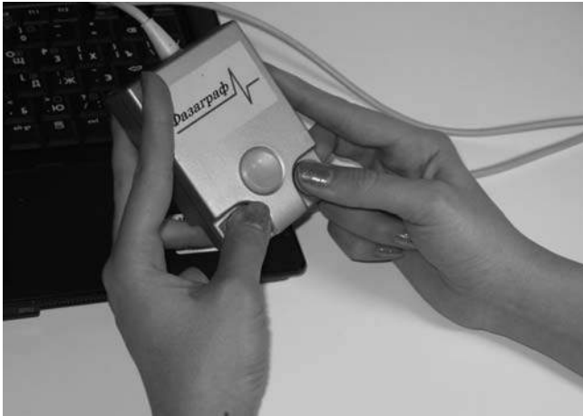
Рисунок 1 — Мікропроцесорний сенсор приладу ФАЗАГРАФ®
