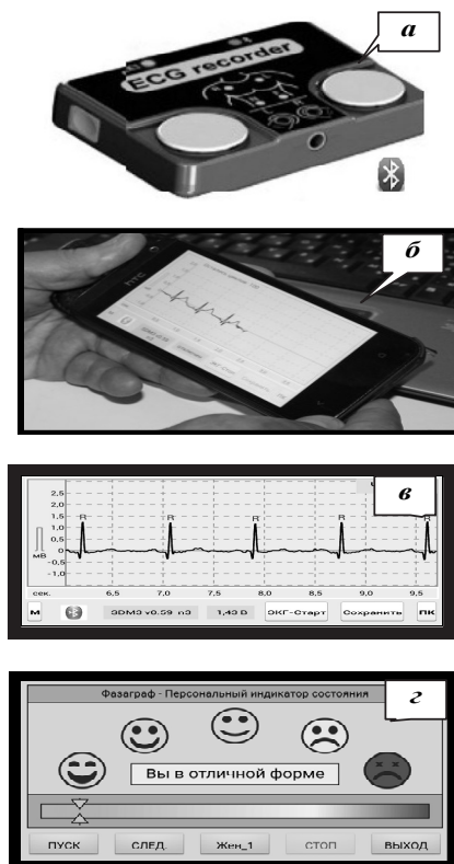
Рис. 11. ФАЗАГРАФ® на смартфоне: а — регистратор, б — смартфон, в — экран ввода ЭКГ, г — персональный индикатор
