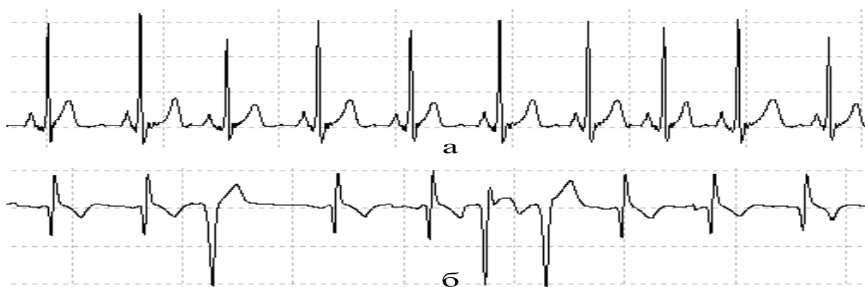
Рис. 1. ЭКГ- сигнал, порожденный моделью (6): по одному эталону (а); по двум эталонам (б)
