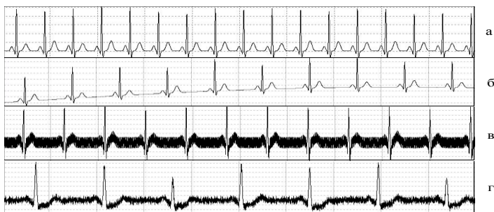
Рис. 1. Примеры искусственных ЭКГ во временной области: (а) – синусовая тахикардия; (б) – дрейф изолинии; (в) – частотные помехи; (г) – депрессия сегмента ST, мышечный тремор
