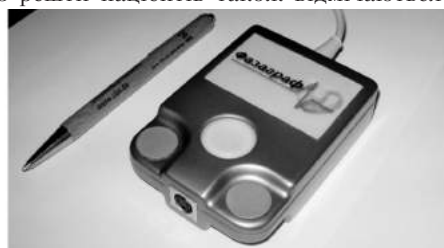
Рис. 1. Мікропроцесорний сенсор пристрою «Фазаграф»
